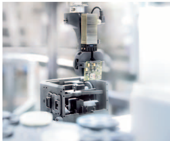
Einsatz eines elektrischen SCHUNK 2-Finger Parallelgreifer EGP für das exakte Handling von elektronischen Bauteilen.
