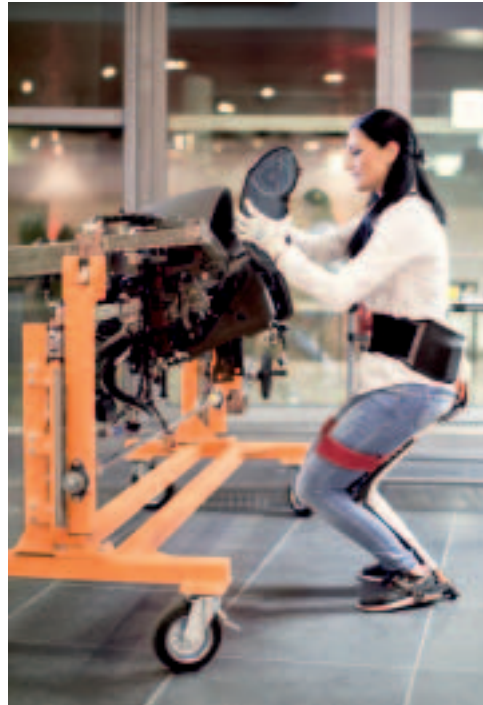
Testlauf bei Audi: Die Facharbeiterin hat sich das Tacho-Element geholt und sitzt bei der Montage bequem auf dem stuhllosen Stuhl von Noonee.
